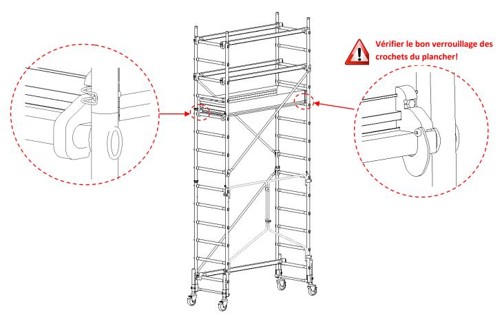
Vous pouvez désormais monter sur les échelles (si besoin) car l'échafaudage est sécurisé pas les stabilisateurs, et renforcé par les lisses.
