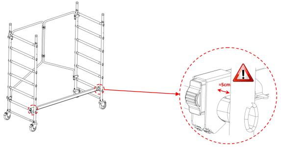
Relier les deux échelles de base par la diagonale placée à l'extérieur des montants. Sur la version à roues réglables, il est nécessaire de baisser la flûte afin de monter la diagonale. Afin de ne pas avoir à répéter cette manœuvre, la diagonale peut être gardée montée sur l'échelle de base.
