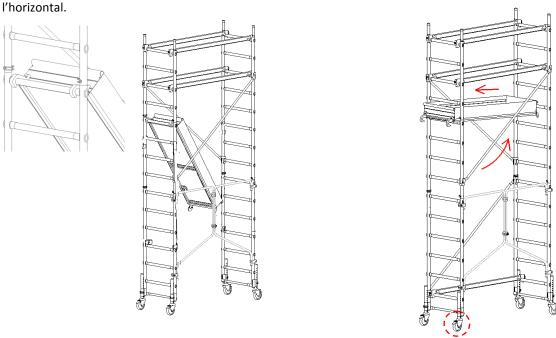
Ramener le plateau vers l'intérieur de manière à poser les supports sur l'échellon
