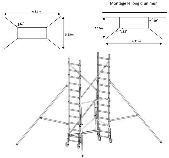
Afin de mettre les stabilisateurs en tension, desserrer l'écrou papillon situé à la jonction des deux parties de stabilisateur, puis presser légèrement sur la chape afin de la faire glisser vers le bas, puis resserrer l'écrou.
