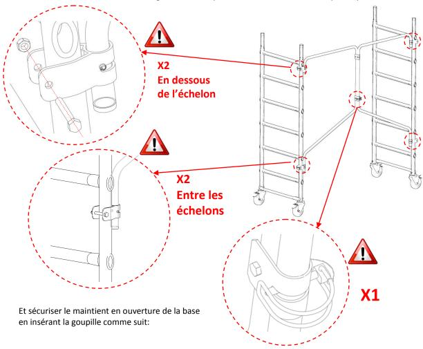
Relier les deux échelles de base avec la lisse placée à l'intérieur de chaque montant, et refermer les crochets:
