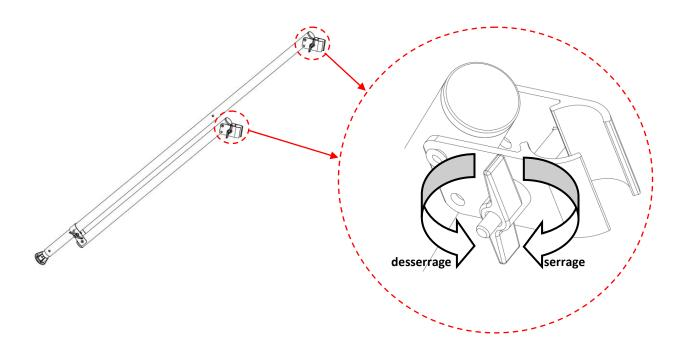
Les pinces de stabilisateurs doivent être placées en butée sous l'échelon concerné (Cf schémas chap 1-3 P 5 et 6)!
