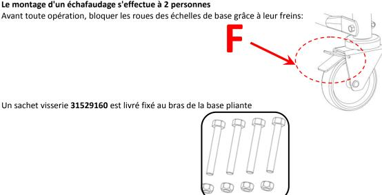
Assembler les deux échelles de base grâce à la base pliante, et les vis du sachet tel qu'indiqué ci dessous:
