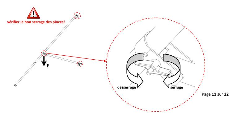
Placer le premier couple de lisse sur les échelons indiqués sur les schémas en chap 1-3 Pages 5 et 6, à l'intérieur des montants.
