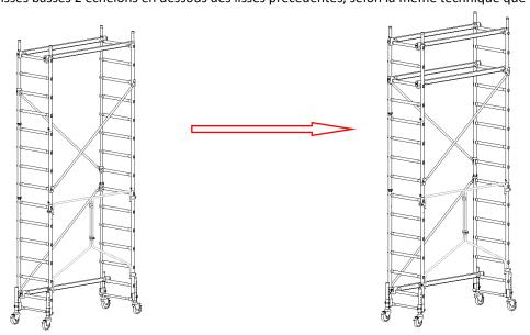
Installer le plancher deux échelons en dessous des lisses basses.
